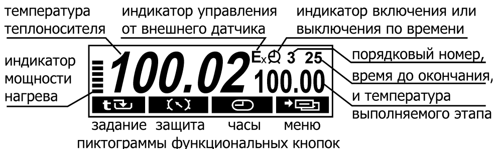
Рисунок 5 — Дисплей в режиме регулирования по программе
