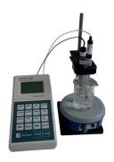
Удобный сценарий работы полностью автоматизированные расчеты результат сразу появляется на дисплее прибора в требуемых по нормативным документам гибкая комплектация Поставляются в портативном и стационарном исполнении Нитратомер Микон-2 растительная продукция - микропроцессорный анализатор «Эксперт-001-3 (0.1) «\* со специальным ПО «Микон», ионоселективый электрод ЭЛИТ-021 для измерения нитратов в растительной продукции, соках, кормах растительных, посвах
