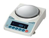
Класс точности – Высокий – II (ГОСТ 24104-01) НПВ: 3200 г. Дискретность: 0,01 г. Калибровка: Внутренняя Возможность измерения плотности веществ и работы с магнитным материалом при помощи стандартного поддонного крюка. Режимы процентного взвешивания, штучного подсчета изделий с функцией АСАI, компаратор. Гарантия 5 лет
