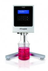
предназначены для проведения исследований по методу Брукфильда . Отображение установленной скорости, текущего значения вязкости в сПз (мПа\*с). Определение динамической (сПз или мПа-с) или кинематической (сСт) вязкостей (при вводе данных о плотности образца). Диапазон вязкости, сПз (мПа\*с) от 20 до 106 000 000 (3 модели). Количество скоростей 18. Диапазон скоростей, об/мин 0,3 до 100
