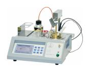
предназначен для определения температуры вспышки в закрытом тиле по методу Пенски-Мартенса. Автоматический алгоритм контроля скорости нагрева, включающий одновременное управление нагревательной и охлаждающей системами, позволяет снизить погрешность поддержания скорости нагрева до минимально возможных значений.
