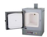
Диапазон температуры: 50-1100 С. Исполнение: без вытяжки или с вытяжкой. Объем внутренней камеры – 50 л. Внутренние размеры камеры 350 х420 х350 мм Терморегулятор: одноступенчатый или многоступенчатый. Время разогрева до максимальной температуры от температуры окружающей среды, мин, не более 90 мин. Отклонение температуры в любой точке по объему камеры в установившемся температурном режиме от температуры в точке установки термопреобразователя электропечи, °С, не более ±15
