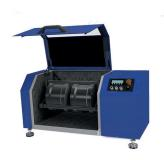
ГОСТ 33024-2014 / EN 1097-1 / EN 13450 предназначена для определения сопротивления истиранию зерен щебня (гравия) по показателю микро-Деваль. Скорость вращения барабанов 100±5 мин-1. Толщина стенки барабана 10 мм. Внутренний диаметр барабана 200 мм. Длина барабана 155 (400) мм. возможна установка двух барабанов длиной 155 мм или одного барабана длиной 400 м
