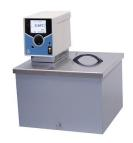
Диапазон температур Токр+10 ... +150 С. Точность поддержания температуры, °С ±0,1. Объем ванны от 8 ло 24 л. Двухкамерный нагнетающе-всасывающий циркуляционный насос обеспечивает эффективное перемешивание теплоносителя внутри ванны и высокую точность поддержания температуры внешней системы не только замкнутого, но и открытого типа. Подключаемый к водопроводу охлаждающий змеевик для достижения температур ниже комнатной (входит в стандартную комплектацию
